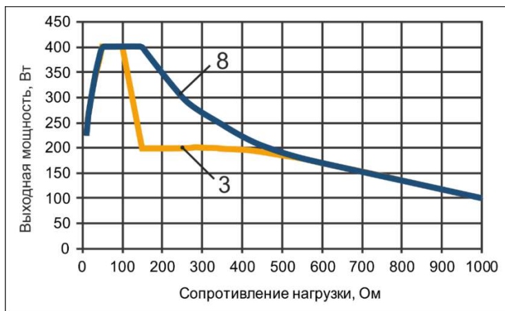
Рисунок А.46 – Зависимость выходной мощности от установленного эффекта при номинальной нагрузке
